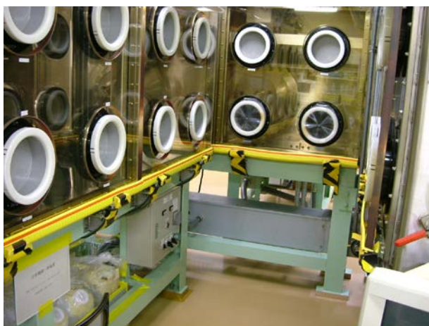
BECKY内のグローブボックス 放射性物質を隔離した状態で分析が行われる
