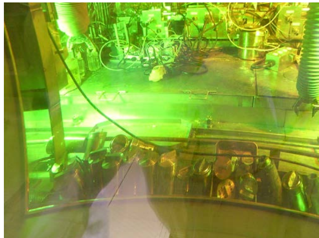
ホットセル内部の様子 厚い鉛ガラスを通してマニピュレーターで操作する
